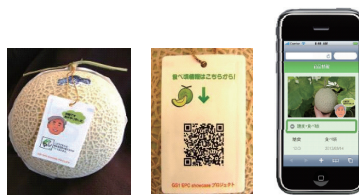
メロンに付けたICタグと読み取りイメージ
