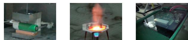
圧潰を想定した釘刺し試験。 火災を想定したバーナー試験。 水害を想定した塩水没試験。
