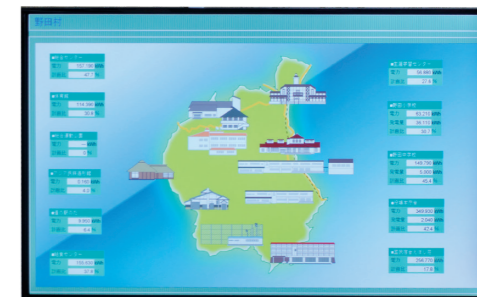
村内11施設の消費電力を「見える化」しているデジタルサイネージ。
